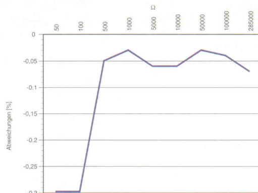
Bild 2. Abweichung des Tek 870 im Wider- standsbereich.
