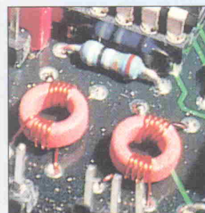
Bild 6. Übertrager selbst gewickelt.
