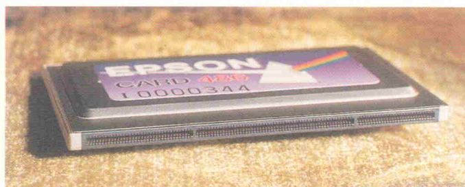
Bild 1. Volle Breitseite: Auf dem 236poligen Systemstecker führt das Card-PC-Modul neben dem PC/AT-Bus auch Schnittstellensignale für die Peripherie heraus.
