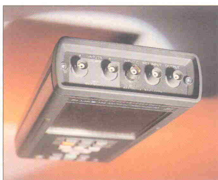
Bild 3. Kopfende – zum Signalanschluß eignen sich Standard-Probes vom Oszilloskop.
